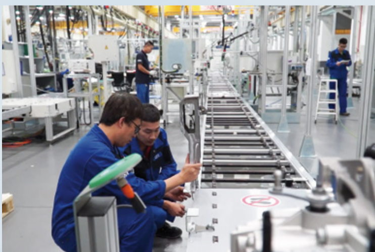
Aufbau einer Montagelinie für Elektromotoren
